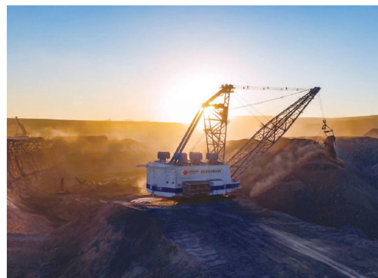
准能集团黑岱沟露天煤矿亚洲最大矿山采掘设备8750-65型吊斗铲
