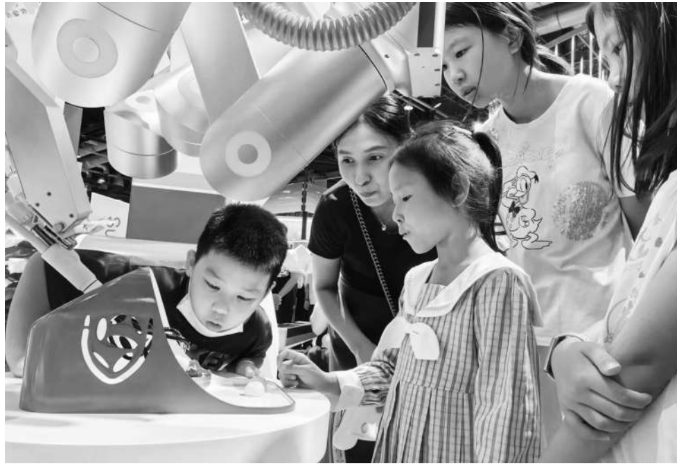
名为“木铎”的腹腔镜单孔手术机器人在工作人员远程操控下剥离蛋壳，剥完后，薄如蝉翼的蛋壳完好无损。
