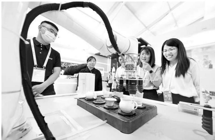
▲在SRT软体机器人展示区,机器人模拟煮茶师倒水、泡茶、倒茶等动作,实现茶饮的全自动制作。据介绍,SRT柔性末端夹具与普通夹具相比,可以温柔无损地抓取工件,具有极高的适应性。在接触产品时,能够自适应地包裹住目标物体,无需根据产品的尺寸、形状、材质等进行预先调整。比如可以抓取陶瓷罐、一次性塑料杯等,如人的手指一般灵活。这个看似不起眼的夹爪,却填补了全球机器人和自动化行业有关方面的空白。
