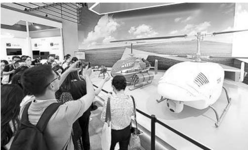
▲在无人机组展区,联合飞机集团的TD550高原高速无人直升机(图右白色)成为其中十分瞩目的展品。据介绍,该机型针对高海拔、高寒等高原环境及相关场景需求设计,实用升限达6500米。此外,该无人机具有升限高、载重大、适应能力强、高原性能好、可靠性高等优势,将有效补齐高原立体运输短板,在高原物流运输、边境巡查、应急救援、林草巡护、农业植保等领域发挥着不可替代的作用。本报记者 齐波 摄
